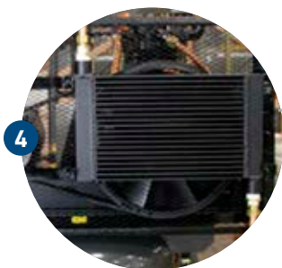
BELTGUARD AFTERCOOLER POS RESFRIADOR MONTADO NO PROTECTOR DE CORREA
